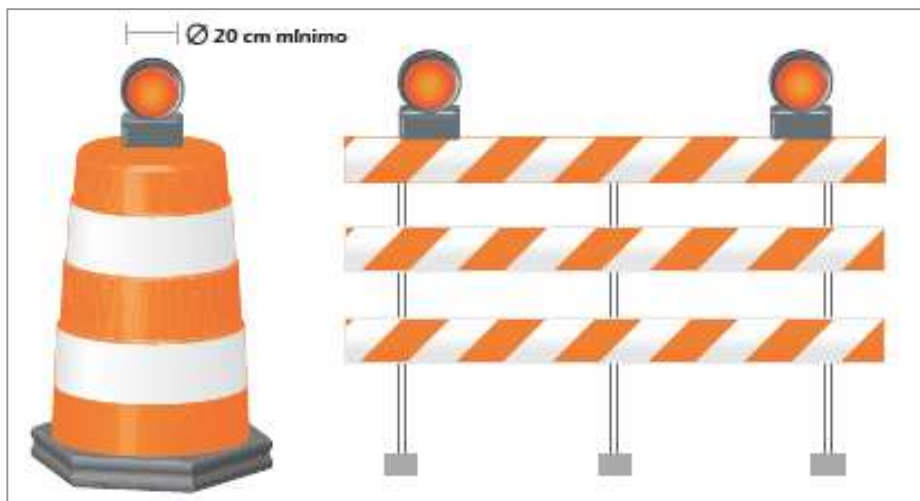
Figura 5.9 Ejemplo de barreras reforzadas con dispositivos luminosos.
