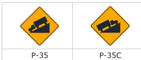
Figura 2.19 Señales preventivas – pendiente longitudinal
