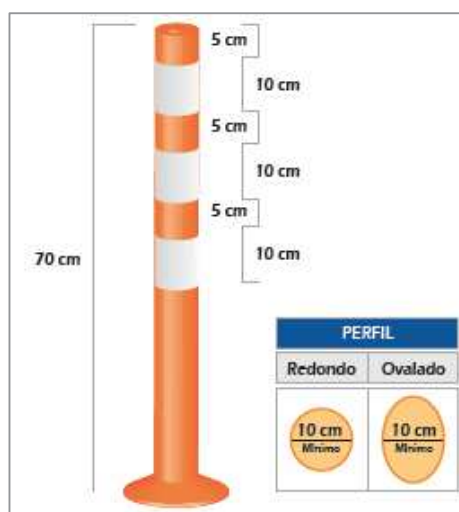
Figura 5.4 Ejemplo de un delineador simple con dimensiones.
