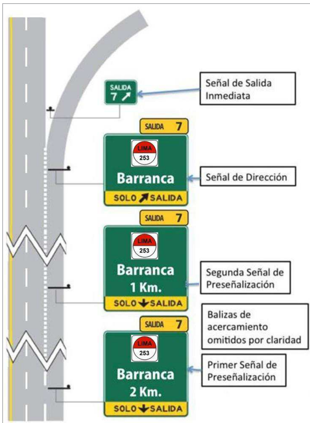
Figura 2.32 Ejemplo de señales de pre señalización en carriles de solo salida o deceleración
