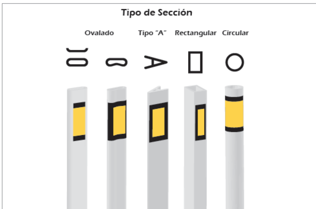
Figura 3.59 Ejemplo de altura y área mínima de material retrorreflectivo en postes delineadores
